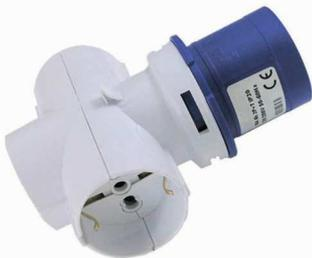
Gli attrezzi elettrici utilizzati nei cantieri al 99% hanno cablato standard da fabbrica la spina Schuko. Essendo obbligatoria la spina industriale nel cantiere, spesso o si taglia la spina originale dell'attrezzo o si utilizzano adattatori industriali che trasformano una presa industriale in una presa domestica e viceversa. Tuttavia, questi adattatori hanno un grado di protezione IP20, mentre la protezione minima nei cantieri è IP44.
